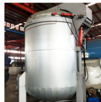
立式高压浸渍罐
