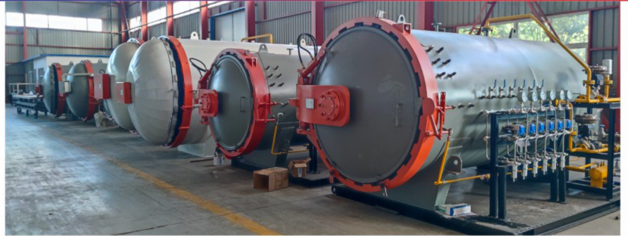
热压罐展厅 Выставочный зал 热压罐实验设备 Термопресс-лабораторное оборудование
