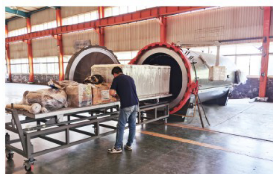
河北2米热压罐
