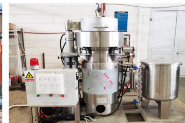
石墨/沥青/树脂浸渍罐
